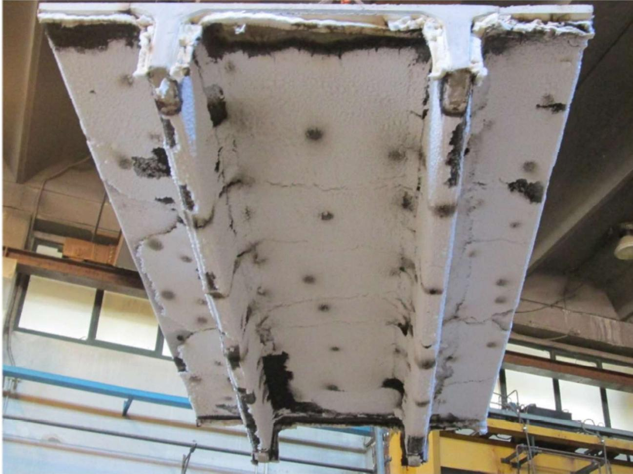
Fotografia della superficie d'intradosso dell'oggetto dopo la prova
