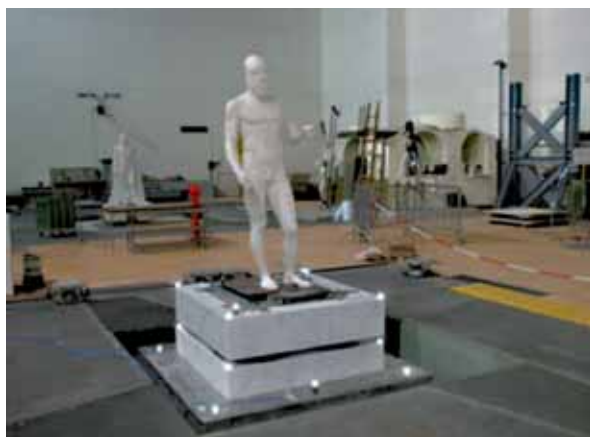
Test basi antisismiche per l'installazione delle statue dei Bronzi di Riace - ENEA Casaccia (Roma)
