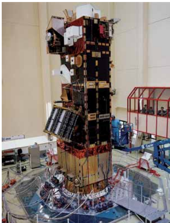
Prova sistemi spaziali - Tavola multiassiale "Hydra" - ESA ESTEC Noordwijk (NL)
