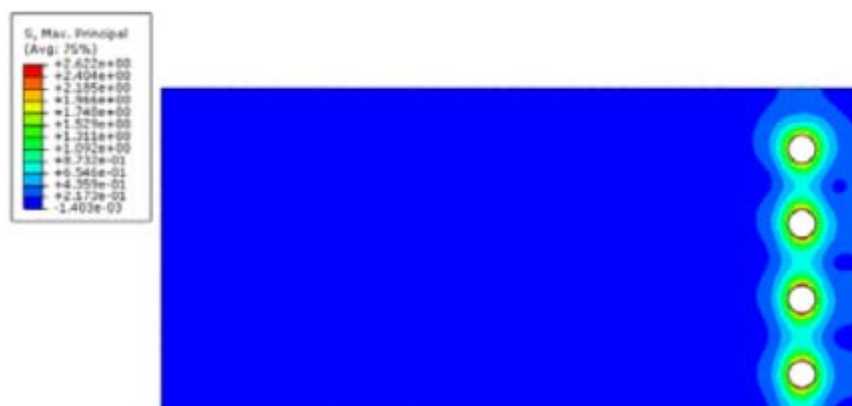
a) D12 bar, c_c=20 mm, i_c=20 mm
