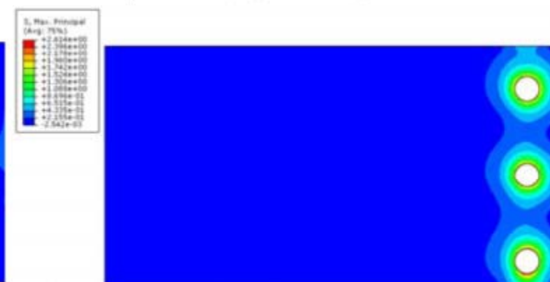
b) D12 bar, c_c=20 mm, i_c=40 mm
