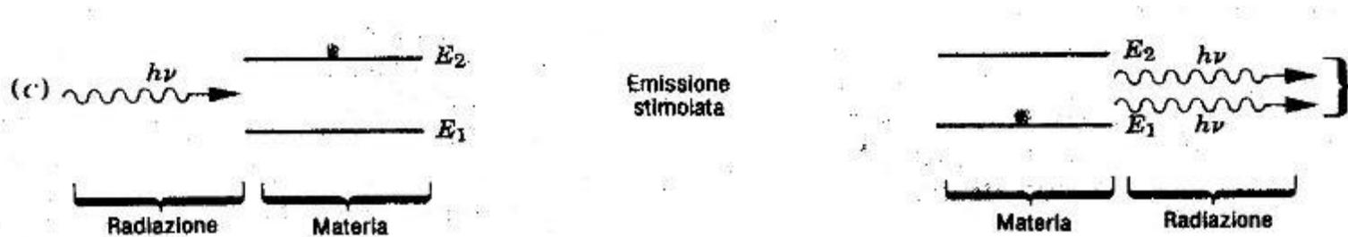
Il fotone emesso è del tutto identico al fotone che inizia questo meccanismo, cioè «stimolante». Ha la stessa energia, direzione, fase e stato di polarizzazione. Per questo motivo la luce laser è strettamente monocromatica, altamente coerente, strettamente direzionale e strettamente focalizzata.
