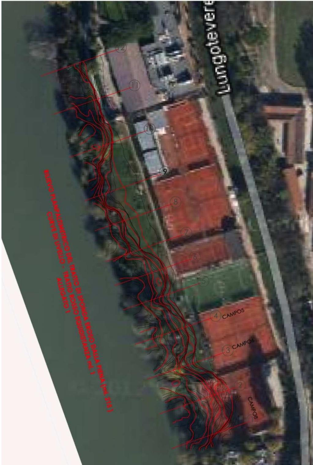
Figura 1 - Restituzione cartografica del rilievo topografico condotto il 23 novembre 2014
