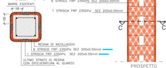
Soluzione di progetto: rinforzo di pilastri con F.R.P. (Fiber Reinforced Polymer)
